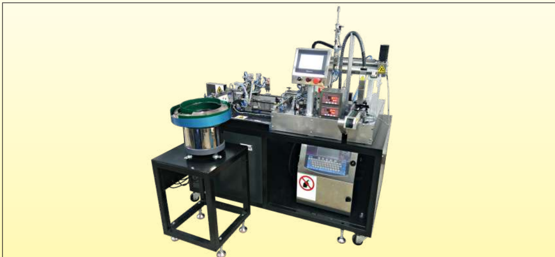
Test automatizzato della resistenza della saldatura in produzione a temperatura ambiente
